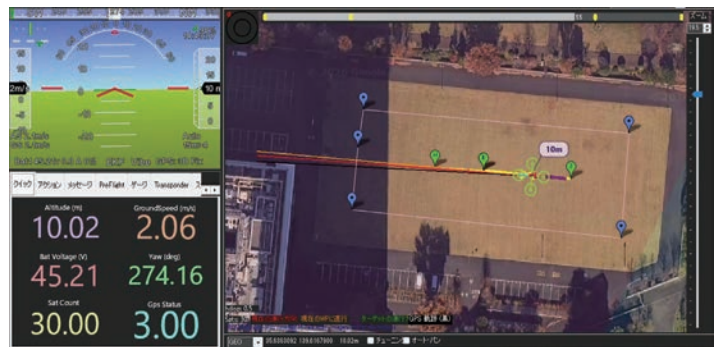
ドローンの監視・制御画面 (飛行位置などの監視や自動飛行の制御をFPUで伝送)
