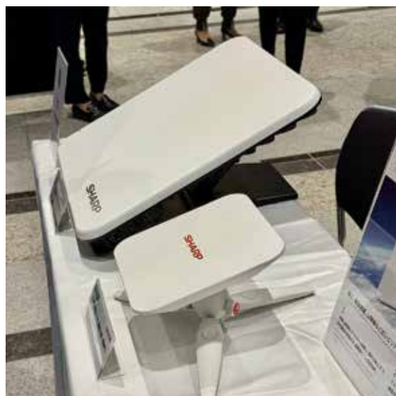
総務大臣賞 電子制御式フェーズドアレイアンテナ搭載小型・軽量 LEO 衛星向けユーザー端末試作機 (シャープ株式会社)
