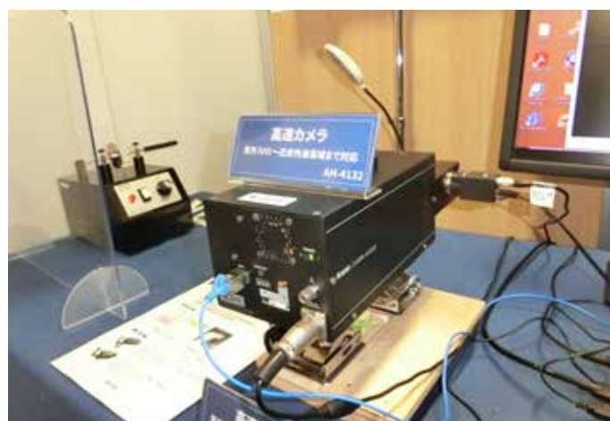
毎秒 1000 枚のハイスピード撮影で、ロケットエンジンの燃焼ガス分析や高速変化の事象を捉えることが可能な高速カメラの紹介説明
