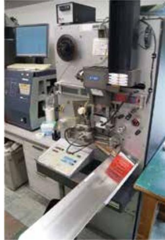
左がオートローダーです。デュプリケートしたテープをカセットに巻き込みカセットテープに作り上げます。写真に赤く写っているのが出来上がりカセットテープです。この後ラベリングなどを施しパッケージ化します。
