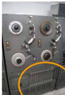
デュプリケーターです。下部に録音特性調整用のスロット基板が並んでいます。各デュプリケーターのバイアス、L/M/H の EQ 調整などの設定が細かくできます。またコントロール基板では 64 倍速までの設定と調整が可能です。とても綺麗に整備されて いました。
