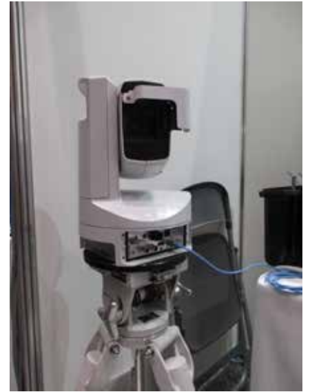
写真 3 「可搬リモートカメラ収録システム」には、キヤノン製 IP 対応 4K 屋外リモートカメラシステム「CR-X300」が採用されていた。
