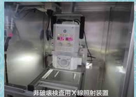
非破壊検査用 X 線照射装置
