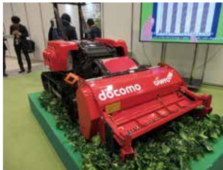
写真3 筑水キャニコム社と共同開発したという「草刈りロボット」は、遠隔操作・自動運転ができるとPRしていた。
