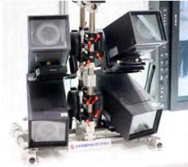
ロケット打ち上げ撮影用マルチカメラシステム
