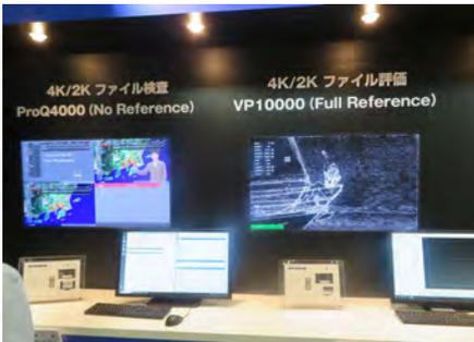
ン上で4K/2K ファイルもしくは12GSDI に対して、ブロックノイズ、ラインノイズ、プチ音等一瞬のノイズをリアルタイムで正確にとらえることができる、映像・音声検査装置を提案。さらに本製品は、光点滅やラウドネス等のガイドラインについても同時計測が可能である。ブースでは、検査結果とエラーキャプチャー機能をハンズオンでの展示紹介を行った。
