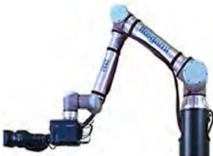
近年、働き方改革として取り組まれてきた省力化・省人化や自動化の流れは、感染症拡大がもたらしたニューノーマルによって加速している。これまで撮影現場では、リモートカメラ、ロボット雲台、クレーン等が撮影の幅を広げてきているが、無人カメラ（無人スタジオ）の導入、リモート撮影や自動撮影、フルリモート配信等が盛んになってきた中、新たな選択肢として映像制作現場に新しいワークスタイルを提供するのがR2 SYSTEMである。遠隔操作による映像制作の省力化、ソーシャルディスタンスの確保（感染症対策）はもちろん、ロボットアームならではの正確な高速移動・画角変化によるダイナミックなカメラワークと、人間の感性的なカメラワークの両立し、従来の物理的な制限を乗り越えている。高度な再現性と直感的かつシンプルな操作で、誰でも容易に撮影することが可能である。
