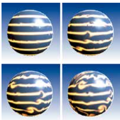
回転する球面上で流体シミュレーションを行ったもの。コリオリ力（回転を引き起こす力）の影響が加えられている。
