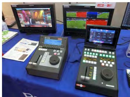
IPを活用した番組制作への関心の高まりにあわせ、IPバックパネル搭載のライブプロダクションサーバ「XT-VIA」、IP接続EVSリモートコントローラ「LSM-VIA」を展示します。新たに搭載されたタッチスクリーンやその他の新機能による効率的なIPプロダクション環境を提案した。
