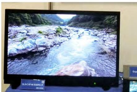
4K入力(12G-SDI×1本、または3G-SDI×4本)に対応した、31.5インチ4K解像度OLEDモニター。中継車や編集室をはじめとした映像制作の現場に最適なピクチャーモニター。
