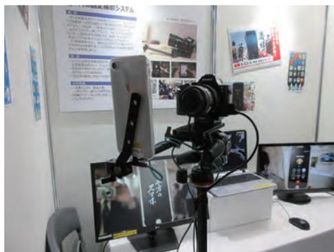
写真4 スマホ固定撮影システムは、スマホが常にカメラレンズのセンターに固定されるように工夫を凝らしている。
