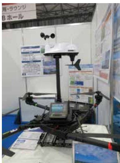
写真2 e ロボティクス社は、アメリカのFreefly Systems社製の産業用大型ドローン「ALTA X」に高高度気象観測データ収集用機器を搭載して出展した。
