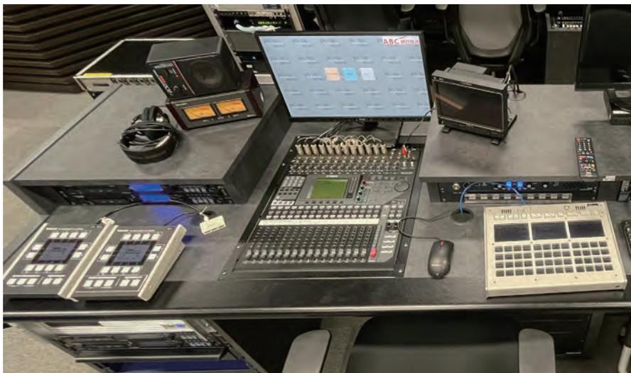
音効(SE)がMIXするコンソールはYAMAHAのO1V。Danteカードを搭載し、Main、SUBコンソールと受け渡しをしている。Danteネットワーク=AUDIOルータとなり、常設するサブ内のコンソール3台すべてが素材を共有している。
