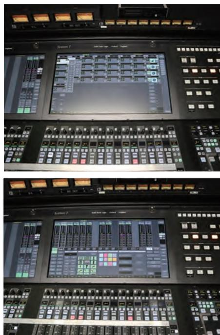
SSL の SYSTEM-T S500。フェーダ数は 48、オーディオエンジンは T80。Dante をコアに採用したフル IP コンソール。二重化されたコアには Dante HC を採用、1024ch の I/O を使用可能。標準の S500 では液晶モニタを立面に搭載しインプットメーターなどを表示するが、今回はモニタを取り外し、両サイドにアームで設置。モニタスピーカーを遮蔽するものを極力排除。モニタリング環境を最優先の構成とした。
