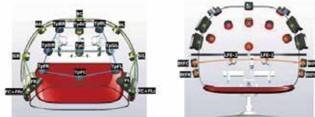
22.2ch 音声スピーカー配置図
