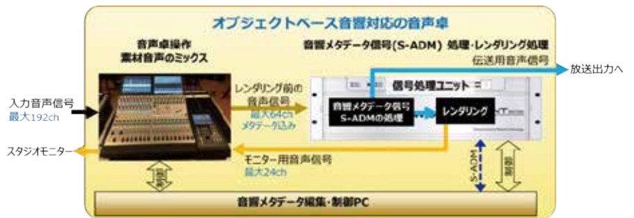
3 音声卓の構成、信号の流れ
