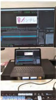
リモートソリューションは、Avid MediaCentral プラットフォームのアライアンスパートナーである Teradici 社（本社：カナダ）の画面転送プロトコル PCoIP® テクノロジーを統合し、編集中に変更のあるピクセルのみを圧縮、暗号化して効率的に転送することで、最新の仮想デスクトップ編集ソリューションを実現しています。また、リモートアクセスのための仲介サーバーと管理サーバーをオンプレミスとパブリッククラウド（SaaS）のハイブリッド環境で構築し、複数のユーザーが同時に、Windows や Mac から、シームレスかつセキュアに多対多のアクセスを行うことを可能にしています。
