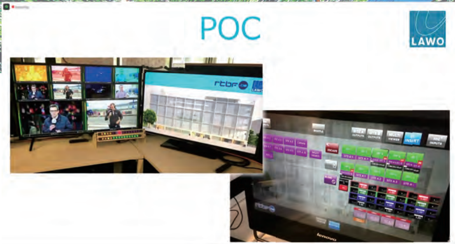
左側は、Vマトリックスのマルチビューアの画面、手前はVSMハードウェアパネル。右側は大画面のタッチスクリーンがありRGBのカラーコレクションなどもパネルから簡単に操作ができるように設定された。
