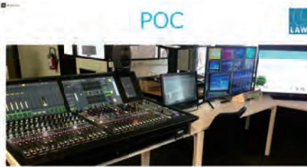
左側は、Vマトリックスのマルチビューアの画面、手前はVSMハードウェアパネル。右側は大画面のタッチスクリーンがありRGBのカラーコレクションなどもパネルから簡単に操作ができるように設定された。
