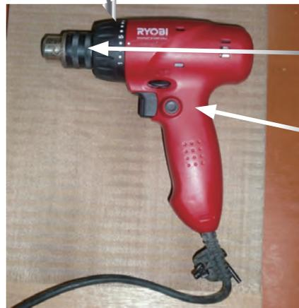
基本的にドライバーというよりもドリルです。従ってビットの取付もドリルスタイルのチャック仕様です。非常に安価な工具なので(3500円くらい)ドリルとしてまたドライバーとしても使えます。ドリルなどの連続使用用にトリガーのロックスイッチがあります。小物の穴あけなどに非常に重宝しています。筆者は小物穴あけなどボール盤を使用していますがちょっとした時に気軽に使えます。
