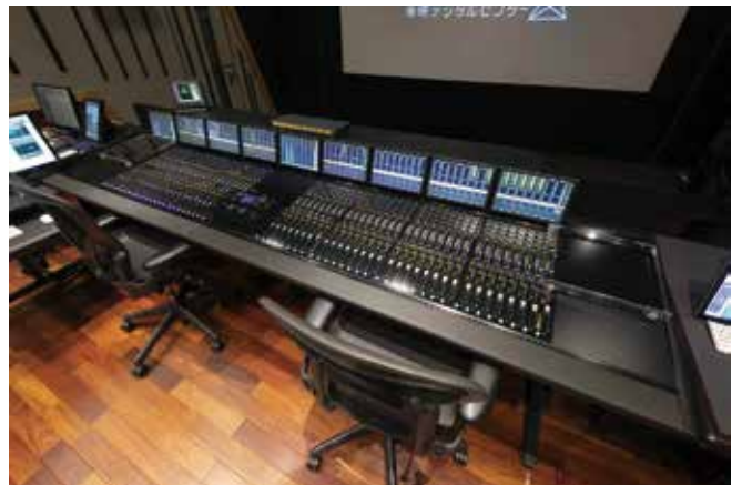
『Dub2』に導入された S6。56 フェーダー/5 ノブ/12 フレームというコンフィギュレーション
