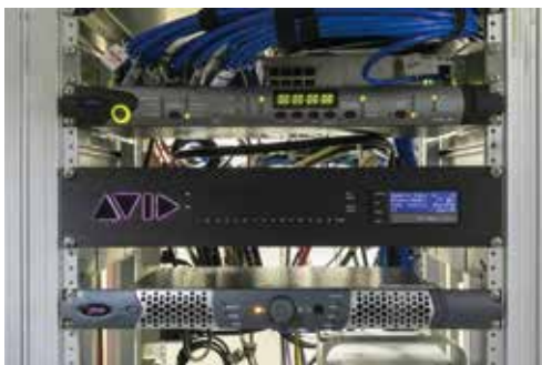
今回新たに導入された Pro Tools | MTRX。レコーダー用の Pro Tools に接続されている
