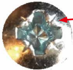
ポジネジの溝 一見プラスに見える
