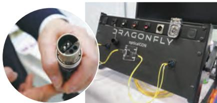
従来一般的なハイブリッドカメラ信号伝送システムよりも堅牢で信頼性が高く、保守が容易。特許取得済みのXB2 テクノロジーを採用したファイバーレンズにより、最小限の損失で非常に堅牢な信号伝送を実現している。また、光学接続部分はレンズとシーリングカバー (オプション)により、汚れや埃に強くなっている。
