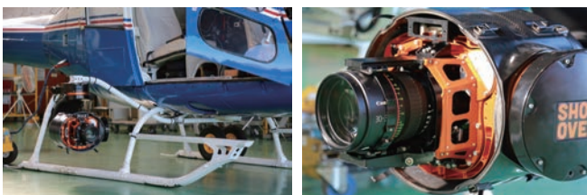
防振装置に装着した 8K カメラと EF シネマレンズ（飛行時は防振装置のカバーを全面閉じています）
