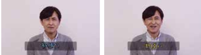
顔の表情を解析して感情に適したフォントを自動表示（同じセリフでも感情の違いをフォントで表現 左：「不安」の感情、右：「楽しい」の感情
