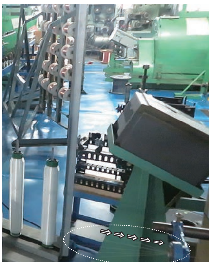
極細の銅線を束ねる(点線内右方向に収束)
