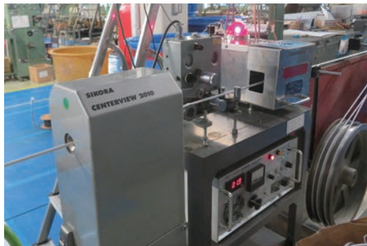
同芯度・肉厚・外径・真円度の測定検査システム
