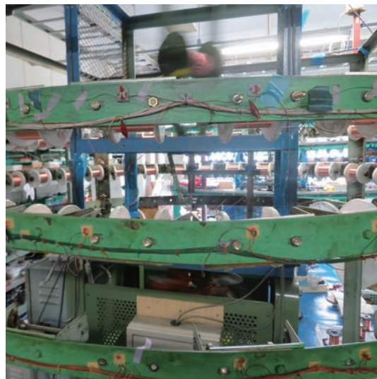
数十本の銅線を周囲に捲く同軸ケーブルの撚機
