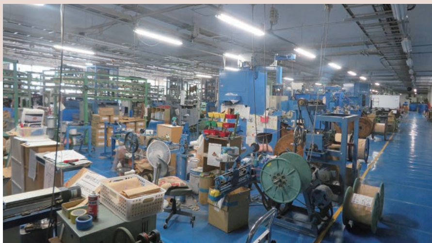
製品の仕様別に異なった撚り機が配置されている工場内の様子
