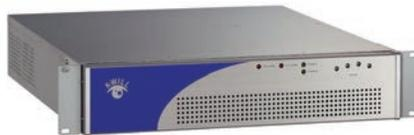
「VP4000」は、2160 59.94p フルサンプルの 4K 基準画像及び評価画像の時間軸を自動補正することで画素同士を比較し、輝度差分値 Y\_PSNR と共に、ITU-T J.144 国際標準方式による DSCQS (二重刺激連続品質尺度) をフレーム単位でリアルタイム計測 (エミー賞受賞)。その評価精度は、ITU-R 500 シリーズによる主観評価と同等で、さらに 8K 画質評価及び HDR 対応へと進化した。ブースでは 4K 画像の画質評価をハンズオンで紹介した。
