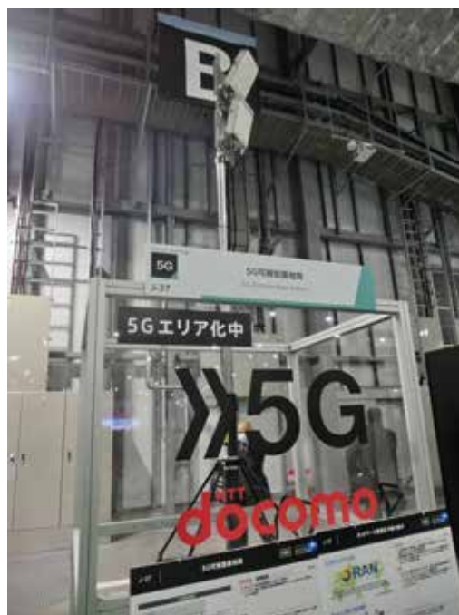
写真1 5Gの会場は、ドコモの可搬型中継局で5Gエリア化がなされていた。
