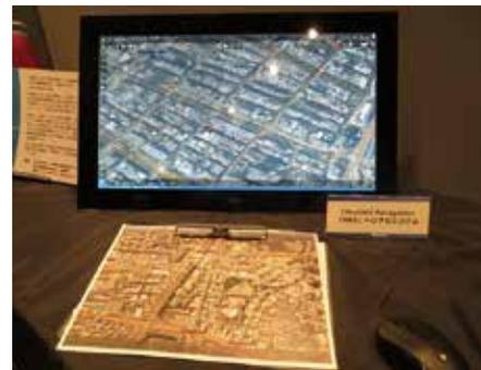
**ワイヤレス伝送・通信機器「TSP-N002」ヘリコプターテレビシステム撮影位置表示装置:**ヘリコプターに搭載された防振装置(カメラ)で撮影しているエリアを、機内で電子地図上に撮影範囲とその中心住所を表示する装置です。他県応援等で地理に不馴れな地域でも、本部や他機との情報交換をスムーズに行なうことが可能。
