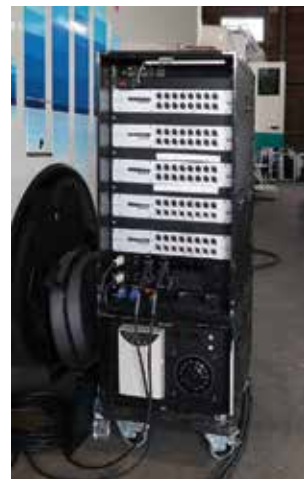
音声中継車とステージボックス間は、Dante で接続
