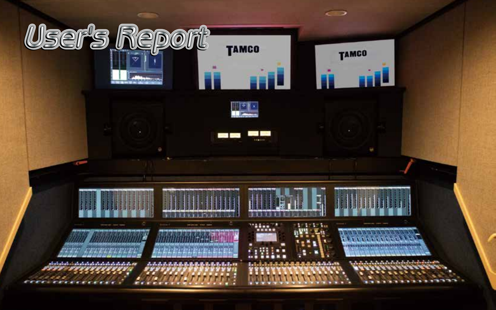
R-1のS500は、64フェーダーフレーム、3タッチスクリーン、2クライアント。
