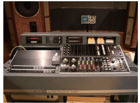
カuttingコンソールはノイマン SP75 VUメーターとピークメータが実装され、各種コンプレッサーやEQなどもあります。各スタジオなどのリンクもここで行われますが、リンクがアナログで行うのかデジタルなのかまたそのフォーマットもこれからの課題です。
