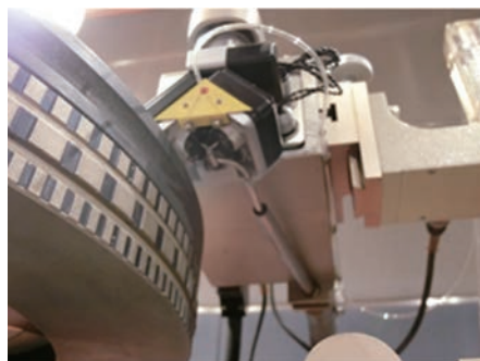
SX-74 ヘッド部分 チューブは冷却用のヘリウムガスと削りカス用のバキュームチューブ、SX-74 特長の回転数確認用スリットパターンが おしゃれ！
