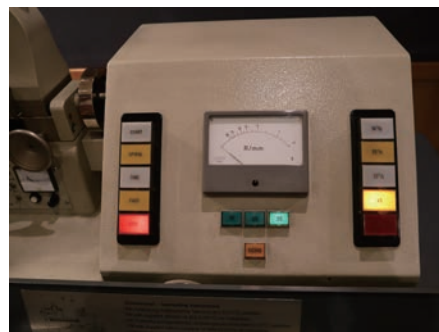
マシンのコントロールボード 中央のメーターは、カッティング溝間隔設定用。カッティングする盤のサイズ指定スイッチがグリーンに点灯。右側には回転スピードの切り替えなどがありコンパクトに構成されている。
