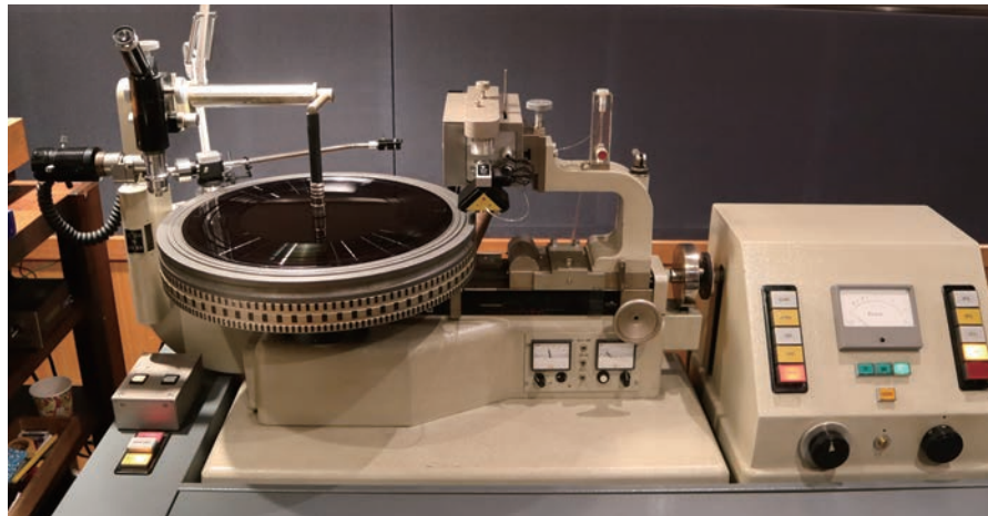
今回稼働することになった、ノイマン VMS-70 驚くほど綺麗に整然と整備されていました。
