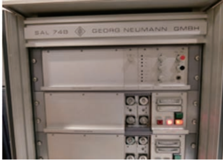
ノイマンオリジナルのアンプ SAL-74 ラック MJ410/MJ423 パワートランジスタのトリプル pp
