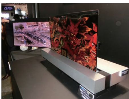
写真2 NHKは、30インチフレキシブル有機ELディスプレイを初出展し、巻き上げ巻き下ろしを実施して来場者の注目を集めた。
