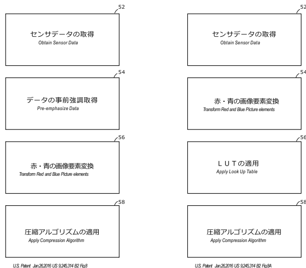
図6 前段階処理フローの一例 (その1)
