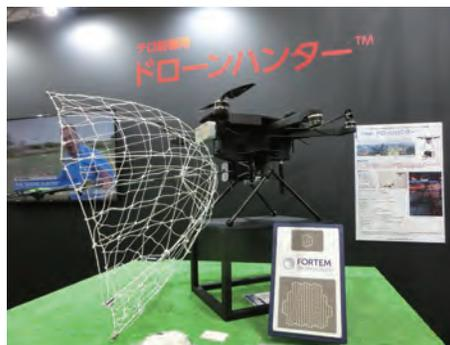
写真 4 スリーライクは、空対空ネットガンでドローンを捕獲する「ドローンハンター」を出展して注目の的になった。
