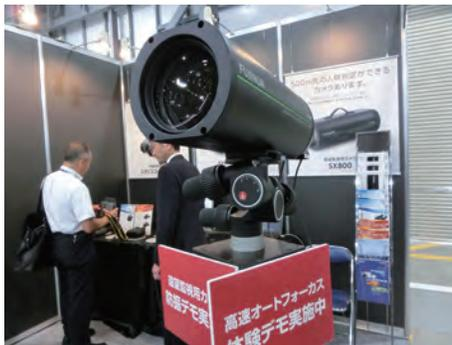
写真 1 FUJIFILM は、500m 先の人物判定ができる光学 40 倍ズームレンズ付き遠望監視カメラ「SX800」を出展して注目を集めた。
