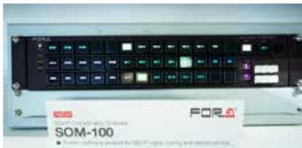
ベースバンド環境とIP環境を統合的に制御・監視でき、ベースバンド/IPを意識しないシームレスな運用が可能。Media Links製IPビデオルーターを活用し、IP方式SMPTE ST 2022-6を使用してデモを行う。
