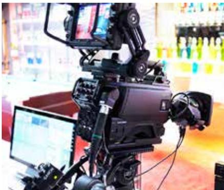
とが可能。カメラヘッドにAC給電することで最大4kmの長距離伝送に対応している。
