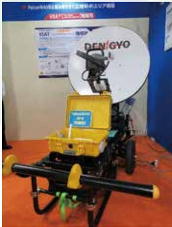
写真4 日本電業工作は、小型衛星通信ターミナルと長距離無線LANシステムを組み合わせた可搬局を紹介して注目を集めた。
