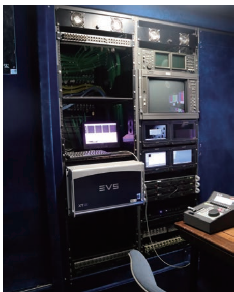
スポーツプロダクションHDビデオサーバ [EVS XT4K]
