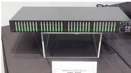
MADI信号(AES-10)の音声レベルを表示する30ドット32チャンネルのバイグラフメータ。「SELECT」スイッチにより、MADI信号の「1~32ch」/「33~64ch」の表示を切換えることが可能。
