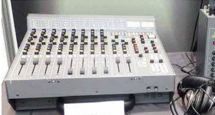
アナログライクな操作性のポータブルデジタルオーディオミキサーで、EIA19 インチラックに実装可能なW420 x H160 x D460のサイズ。デジタル(AES-3id)/アナログ信号混在の12x10 デジタルオーディオミキサー。
