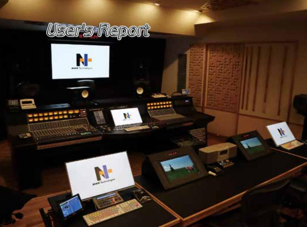
ディレクターモニター（4K 対応）を埋め込み式にして高さを低く抑えるとともに、KVM（IHSE Draco）を導入してモニターの数を減らしたことで、最後尾のクライアント席までスピーカーの音がストレートに届く構造とした。可動式のアシスタントテーブルに設置された PC モニターはフラットにもなる。
