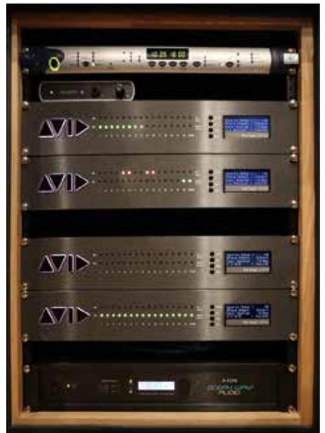
3 台の Protools を含めたすべてのオーディオ入出力は 4 台の MTRX により Protools Main マシンに接続され、Protools 内の操作だけでデジタル・アナログを気にすること無くルーティング可能なシステムとなっている。96kHz のハイレゾ音源制作にも対応。
