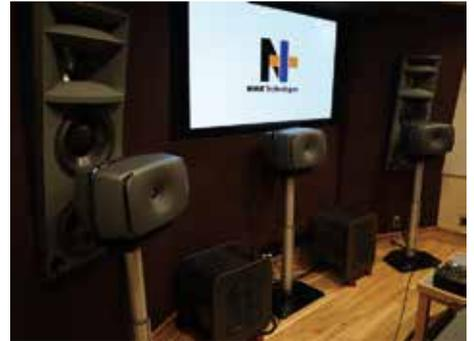
ラージスピーカーは、OceanWay Audio HR3.5 を日本で初めて採用した。5.1 サラウンドの場合などでは、Genelec B351A が水平にせり上がる。
