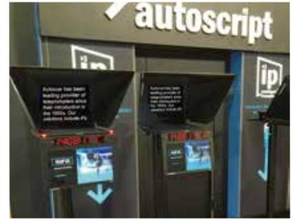
「Autoscript」は、プロンプターシステムのマーケットリーダーとして全世界にソリューションを提供する、イギリスのブランド。プロンプターとは、ニュース番組などで原稿の読み上げを行うアナウンサーが、視線をビデオカメラから外すことなく視聴者に向かっていられるようにするために使用される、ハーフミラーを内蔵した機器であるが、設置性と利便性を高める豊富なアクセサリや、軽量化と高輝度化が進んだプロンプターモニター、視認性を高めたプレビュー画像表示用モニターなどを組み合わせ、個々のニーズにマッチしたシステムを構築することができる。
