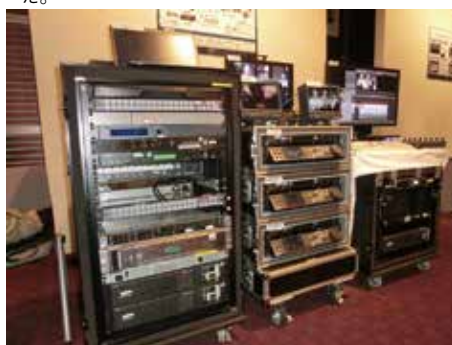
写真4 中継現場で回線収録、ハイライト編集、送出などができる「可搬型ノンリニア編集システム」が披露されて関心を呼んだ。
