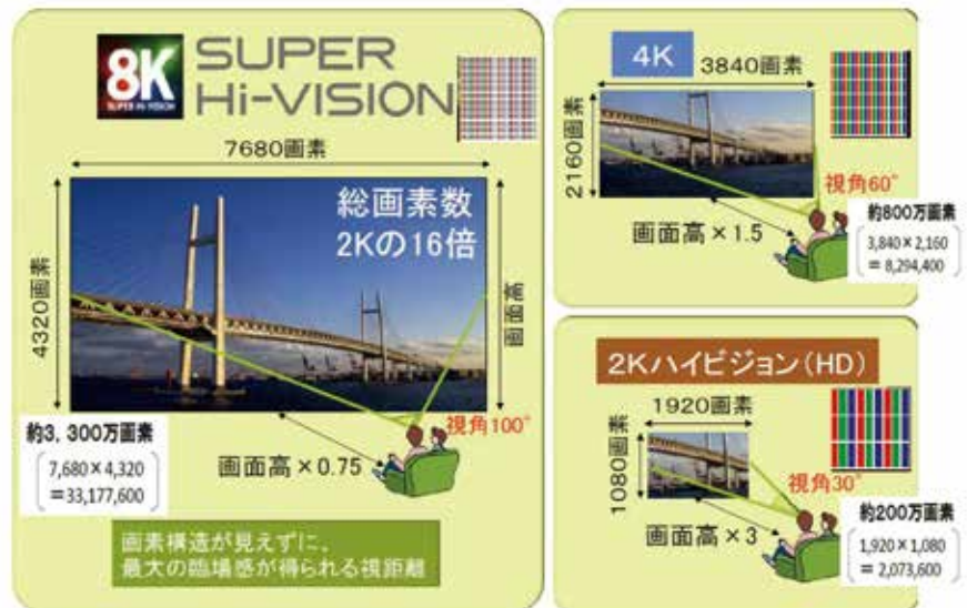
図4(a) 8Kメディアの主な特性 総務省ICT研究開発セミナー 2016年1月29日(金) 発表資料をもとに加筆
