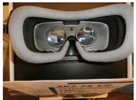
写真3 ジャパンディスプレイが公開した世界最精細度の「4K 2.5K 120Hz 1001ppi」を誇るVR HMD。
