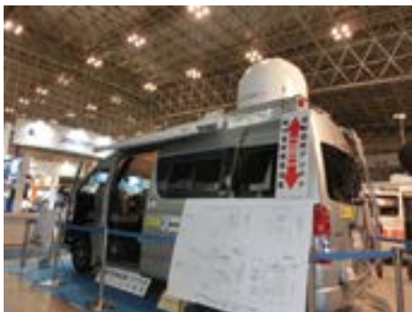
写真1 エーティコミュニケーションズは、レドーム入りの衛星自動追尾アンテナを車内・車外に出し入れできるように工夫した衛星中継車を展示して来場者の意表を突いた。
