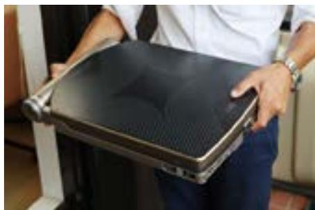
ラップトップ PC 大のサイズ<sup>\*1</sup>、重さ約 8kg という持ち運び負担の小さいモデルでありながら、定格出力 50W のアンプ、通信用モデム、Wi-Fi 機能など、通信に必要な機器を全て内蔵し、この 1 台で衛星の捕
