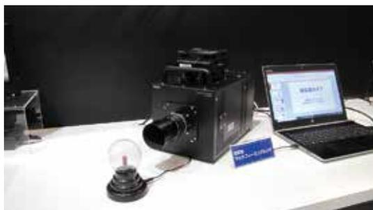
写真 10. 超高速マルチフレーミングカメラ
