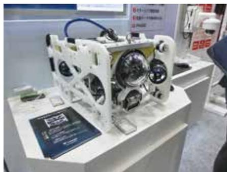
写真2 Fulldepthは、7基の推進器を搭載し、リアルタイムに撮影データを送信できる水中ドローンを展示して注目を集めた。
