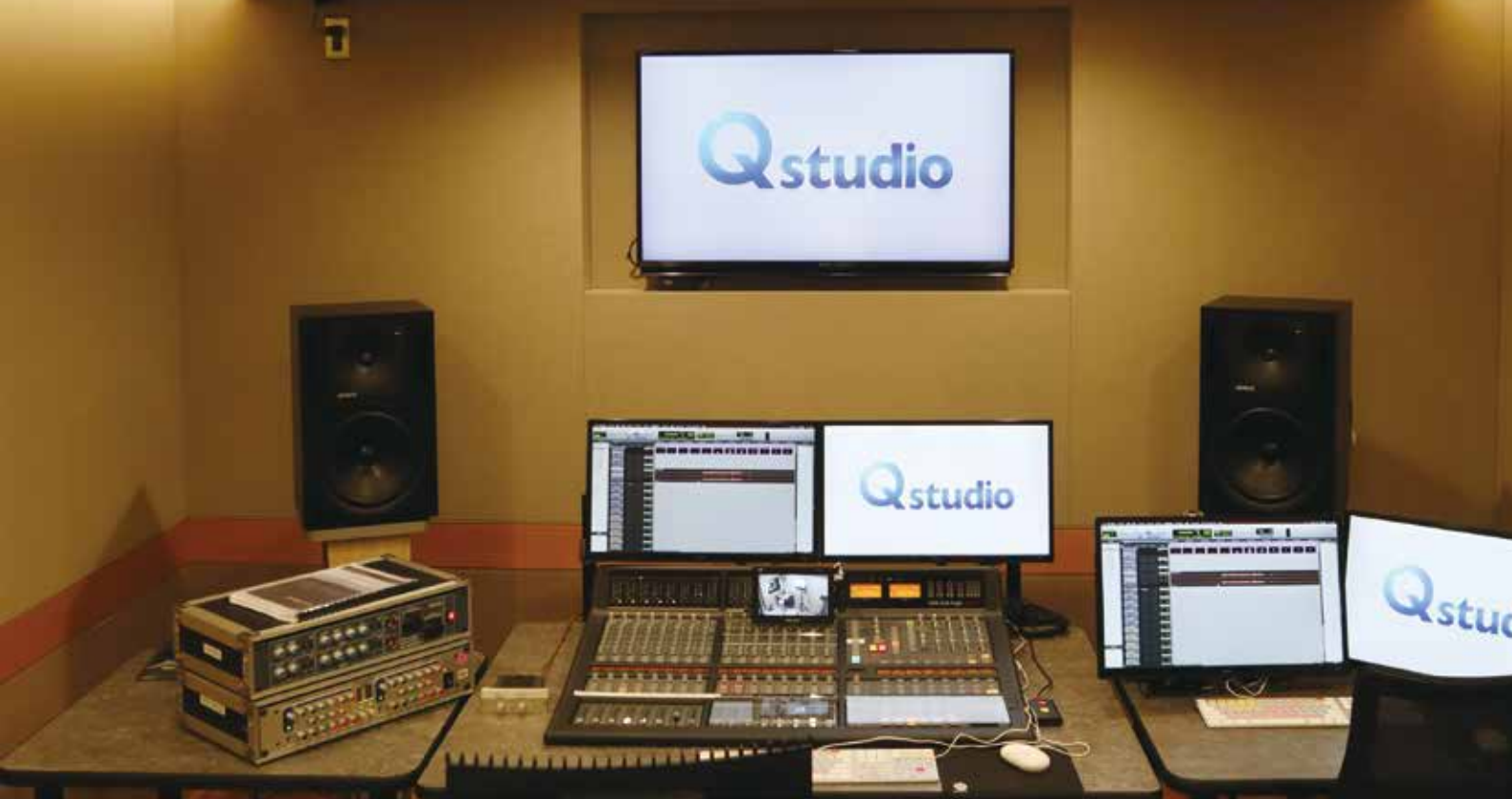
Q スタジオコントロールルームに導入された SSL Matrix 2 、卓上左側には自社製のイコライザー Over Quality KE-922 が並ぶ。
