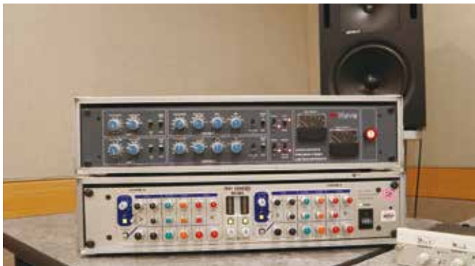
卓上のイコライザーは、オーバークオリティ（自社オリジナルブランド）とブース側には足元にヘッドアンプが配置され、リモート制御が可能。
