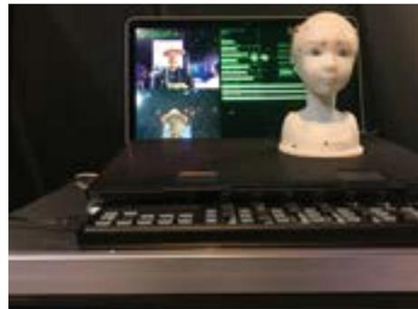
写真12 エマージング・テクノロジー (E-TEC)に出展された「SEER: Simulative Emotional Expression Robot」は、カメラで取り込んだ人の視線や表情をリアルタイムに捉え、アニメチック・ロボットの表情に反映するシステムで、目や眉毛の動きなどが表情豊かに表現されていた。(Takayuki Todo氏による出展)
