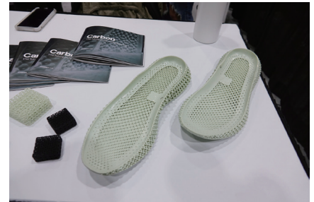
図 19 Carbon 社の 3D プリンターで出力したスニーカーのソール
