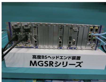
写真2 ミハル通信は、「MGSRシリーズ」と呼ぶ高度BSヘッドエンド装置を前面に押し出して出展した。
