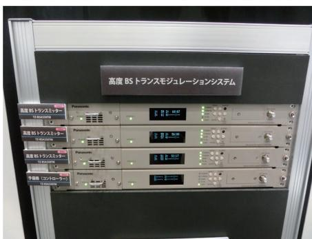
写真1 パナソニックは、トランスミッター3台と予備機1台で構成されたトランスモジュレーションシステムを出展して注目を集めた。
