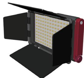
95以上。照射角は110°以上。ハウジングにはAL60系列のアノダイジングアルミニウム合金を採用し、220gと軽量化に仕上がっているほか、部品密度を高く設計し、わずか14mmと薄くなっている。バッテリーはサムスン製の3,300mAの交換可能な大容量バッテリーを内蔵。USB端子経由で充電できる。またmini10-aはバッテリーの他、DC7-24Vの外部電源入力にも対応。
