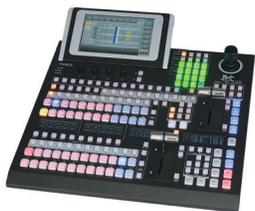
HVS-1200は、4K対応スイッチャーでありながら可搬性に優れたコンパクトな3Uの筐体を採用し、中継車やイベントでの活用に最適なビデオスイッチャー。HVS-100/110やHVS-490の機能・操作性を継承しながら、全入出力を12G-SDIに標準対応することで、4K UHD時に10入力10出力を実現(\*2)しています。全入力にフレームシンクロナイザーを搭載しており、入力された同期/非同期ビデオ信号のスイッチングに対応。12G-SDIとquad link 3G-SDI (2SI)の混入入力も可能。また、モード切り替えにより、40入力10出力のHDビデオスイッチャーとしても活用できる。
