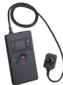
一般的に、ウェアラブルカメラを使って現場と本部間で映像情報を共有する場合、装着者の歩行・走行時の振動による影響を補正し、安定した高画質の映像を撮影することが重要。本機は、ソニーが民生用カメラ商品で培った手ブレ補正技術をベースに開発された強力な電子式ブレ補正機能を搭載、揺れの少ないクリアな映像撮影が可能。補正する揺れの振動周波数や補正領域の範囲を、業務用途で使われる場合の動きに合わせて最適化することで、歩行・走行時における上下左右ならびに回転方向のブレを大幅に軽減する。
