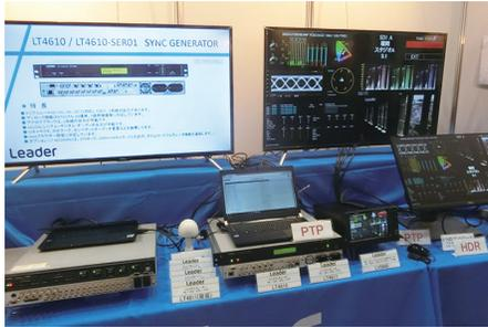
されている。[LV5600]は、7 インチタッチパネルを搭載した3U ハーフラックサイズの波形モニターで [LV7600]は1U フルラックサイズのラスタライザー。映像信号は SD ~ 12G までの SDI 信号と IP 信号に対応している。測定監視機能は、映像から音声、IP 伝送に至るまで様々な項目に対応している。
